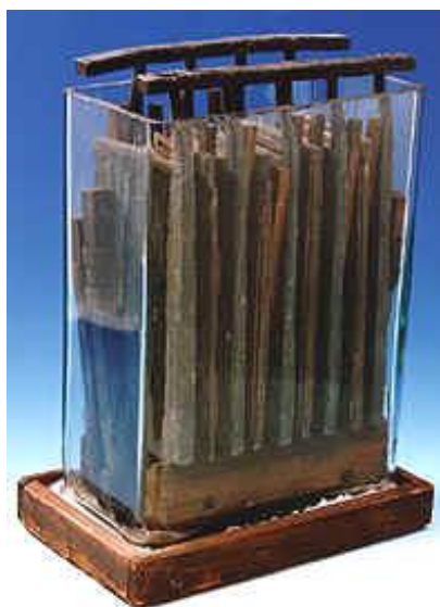
Figura 19 – Primeira bateria de Chumbo-ácido recarregável construída por Gaston Planté
