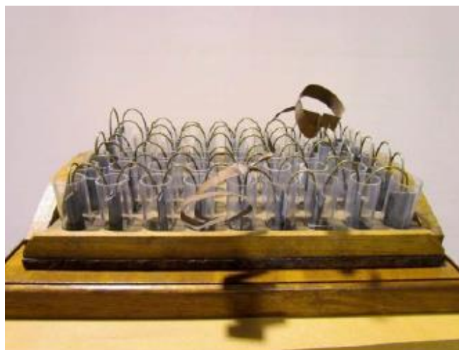
Figura 17 – Réplica em 1991, de uma bateria Voltaica do tipo de coroa de copos. É composto por 54 células zinco-cobre
