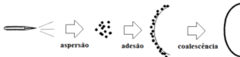
Figura 8 - Representação esquemática do processo de formação de película de revestimento em comprimidos.
