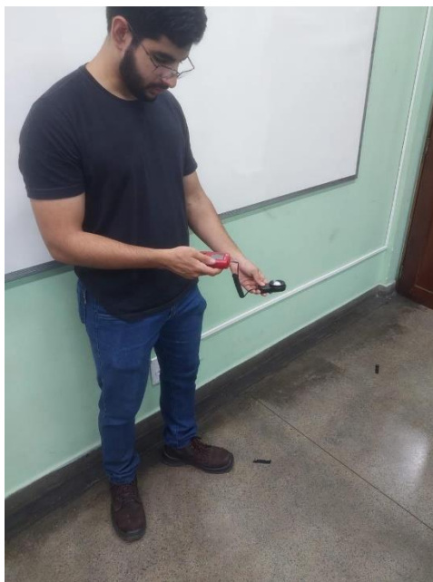
Figura 41 – Medição do nível de iluminamento.
