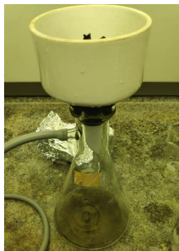
Figura 15 - Exemplo de filtração a vácuo utilizada.
