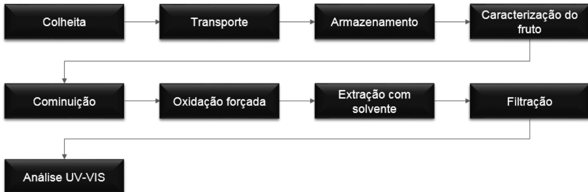
Figura 8 - Esquema geral da metodologia de obtenção do corante azul do jenipapo.
