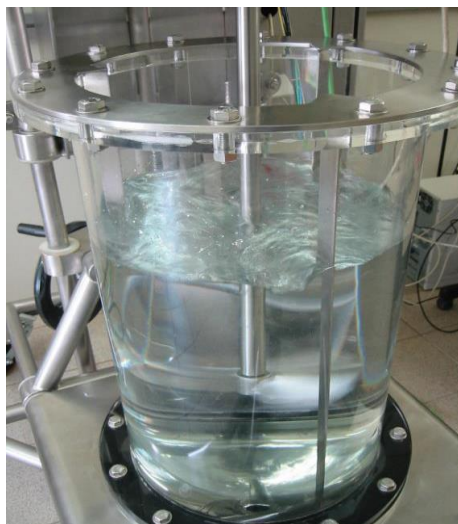
Figura 12 - Tanque de 50 L da unidade piloto.
