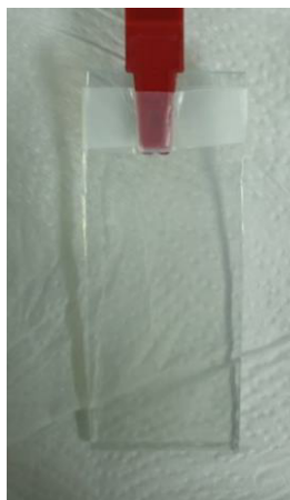
Figura 18 – Eletrodo de trabalho para eletrodeposição de ZnO
