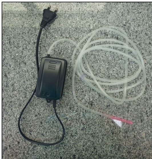
Figura 24 – Bomba de aquário para aeração
