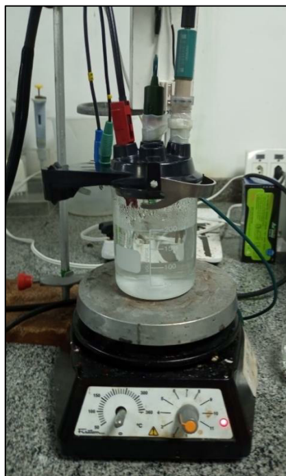
Figura 26 – Sistema de eletrodeposição de ZnO
