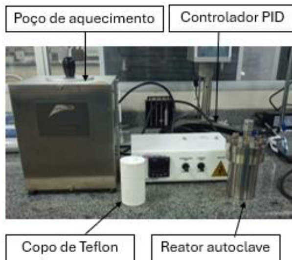
Figura 16 – Reator hidrotermal e sistema de controle térmico
