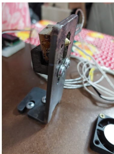
Figura 52: Estruturas para suporte do bloco aquecedor.
