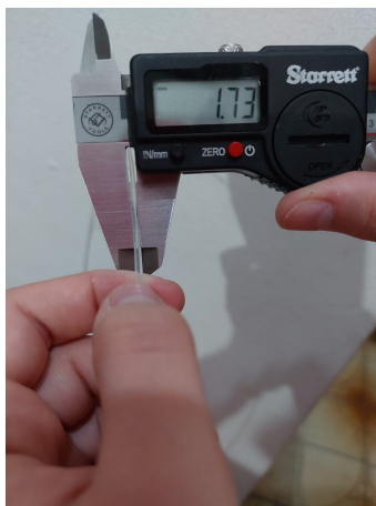
Figura 77: Filamento com tamanho adequado.
