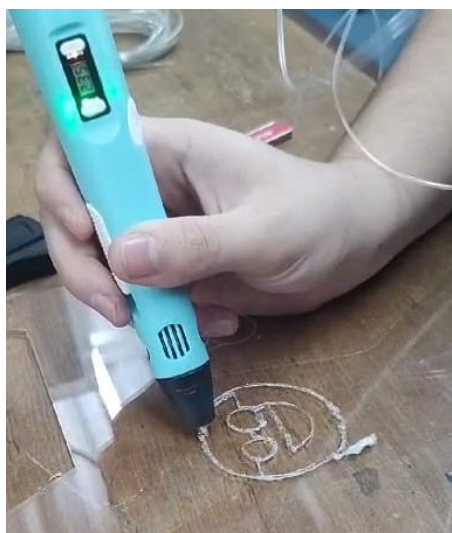
Figura 83: Processo de Impressão 3D com a 3D Printing Pen .
