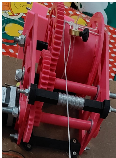
Figura 53: Estrutura para guia do fio para o Bobinador.
