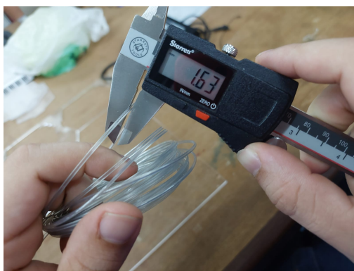
Figura 74: Filamento com diâmetro menor que o desejado.
