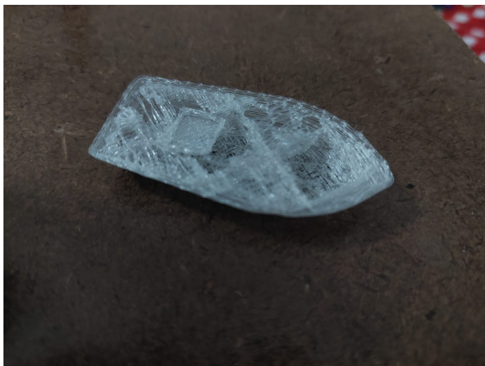
Figura 94: Parte impressa do barco Benchy .
