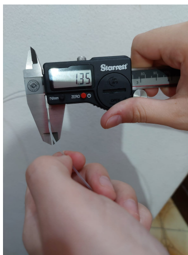
Figura 95: Diferença de diâmetro do filamento produzido.
