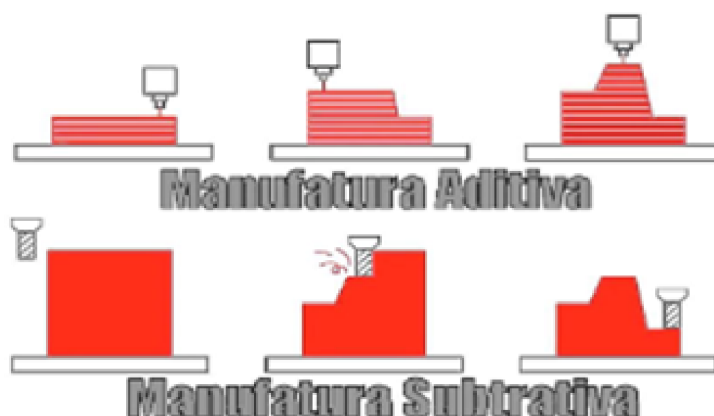
Figura 1: Processos de Manufatura.
