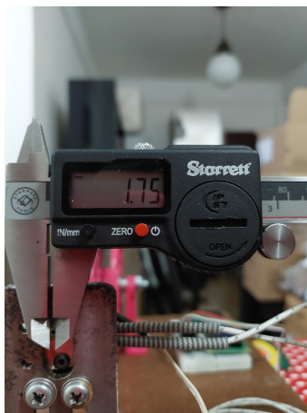
Figura 76: Bico extrusor com diâmetro de saída de 2 mm.
