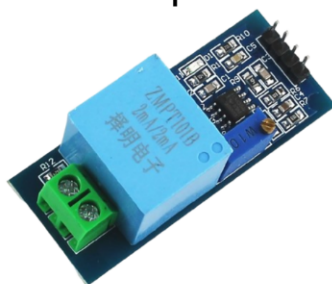
Sensor realiza a medição da Tensão AC
