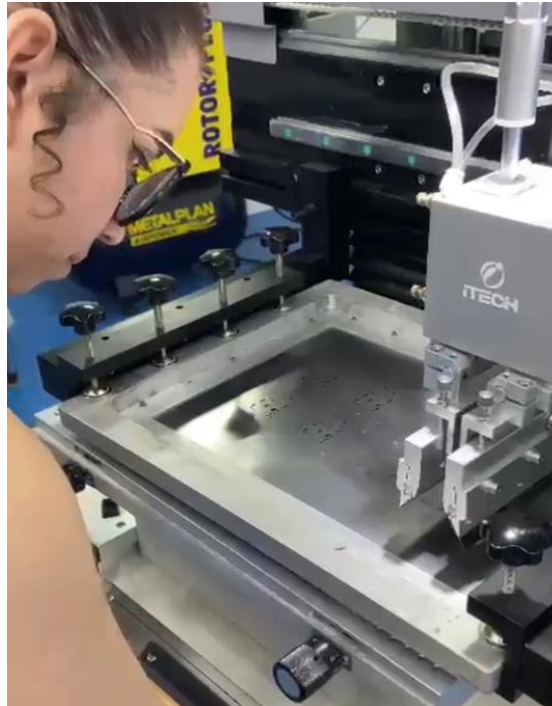
Figura 20 - Verificação do alinhamento do estêncil
